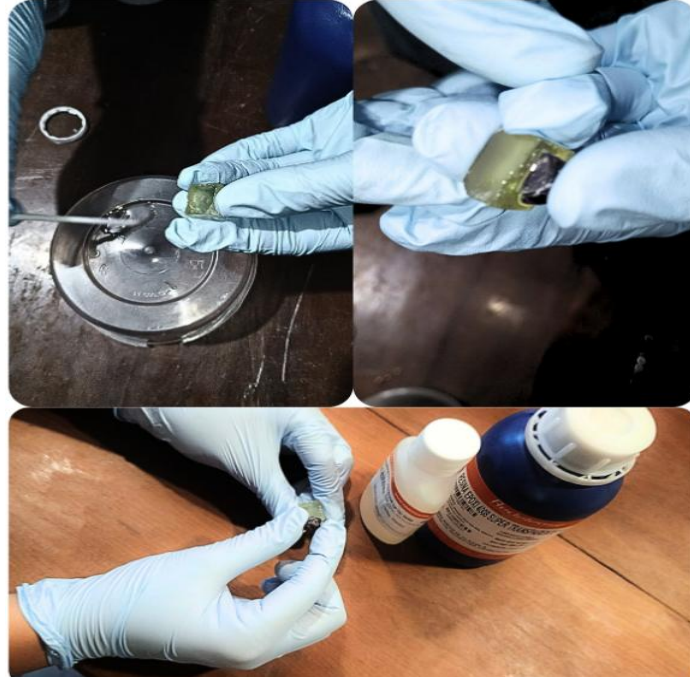
Figura 5 – processo de colagem dos minerais com a resina
