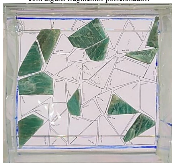
Figura 13: Recipiente de polipropileno com as dimensões da placa virtual e o mapa de contornos logo abaixo já com alguns fragmentos posicionados.
