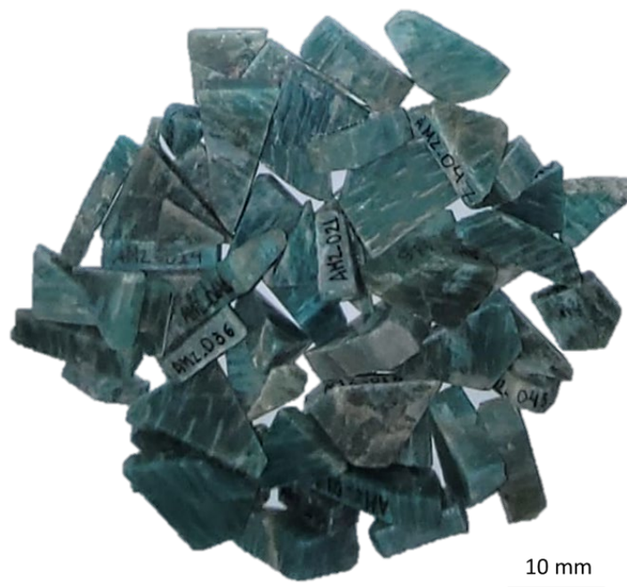
Figura 9: Fragmentos de amazonita cortados e polidos, antes da digitalização.
