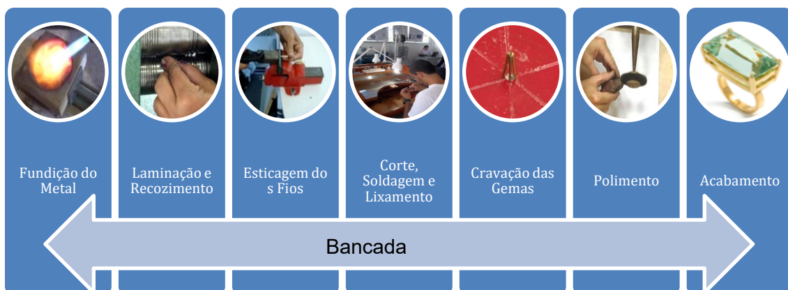
Figura 2: Processos de Fabricação e Montagem de Jóias. Fonte: Elaborada pelos autores (2022).
